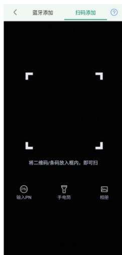
**步骤 6:** 选择扫码添加，首先将 WIFI 棒插入设备“WIFI/GPRS”标志位置，将手机扫码功能打开，正对 WIFI 棒的二维码进行扫码添加。
